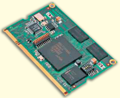
Рисунок 2 Внешний вид SODIMM модуля фирмы Emtrion, партнера компании Renesas
