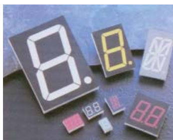
Рис. 5. Семисегментные и цифробуквенные дисплеи
